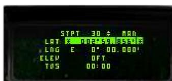
A noter qu'il est possible de passer automatiquement au point de passage suivant à l'approche du point de passage actif (3 nm) via l'icp en pressant la touche 4 et en effectuant un seq juste après.
