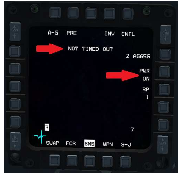
PWR ON + NOT TIMED OUT : les missiles sont sous tension, mais pas encore utilisables.
