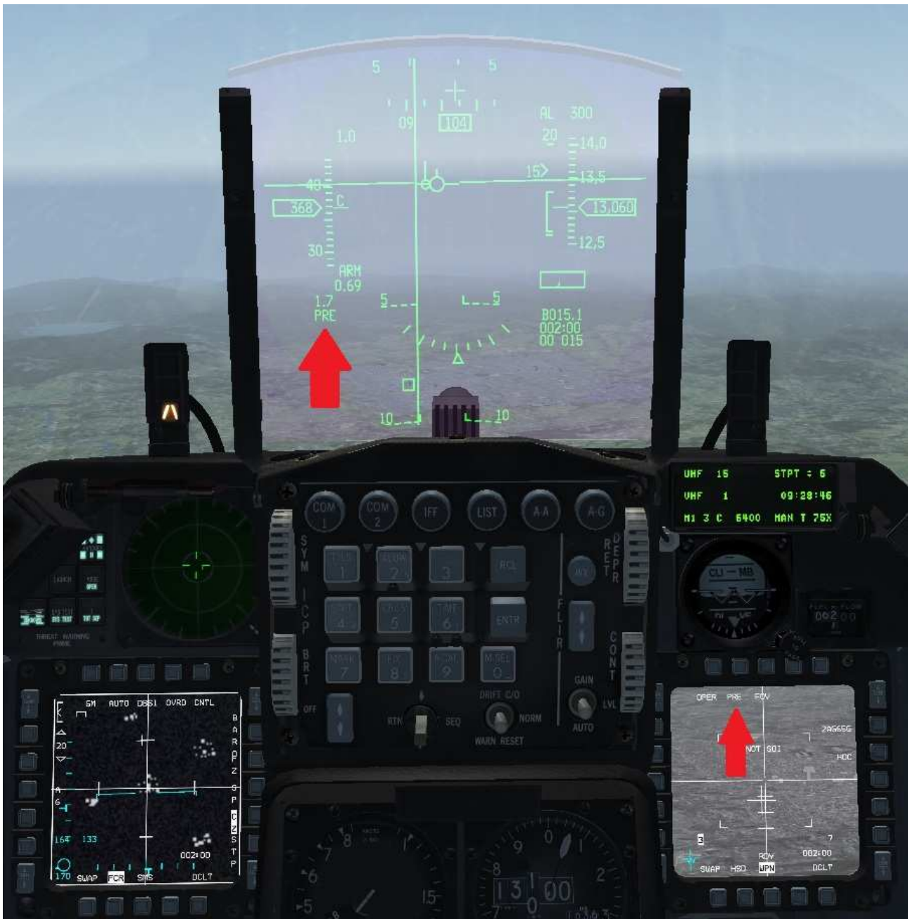
Mode PRE avec le radar 1 : Le pilote a utilisé le CURSOR ENABLE , jusqu'à passer en mode PRE, ce que confirment les mentions PRE dans le HUD et sur la page WPN. Sur l'écran radar, à gauche, il a amené le curseur sur une cible. Sur la page WPN, l'autodirecteur a suivi le pointage du radar.
