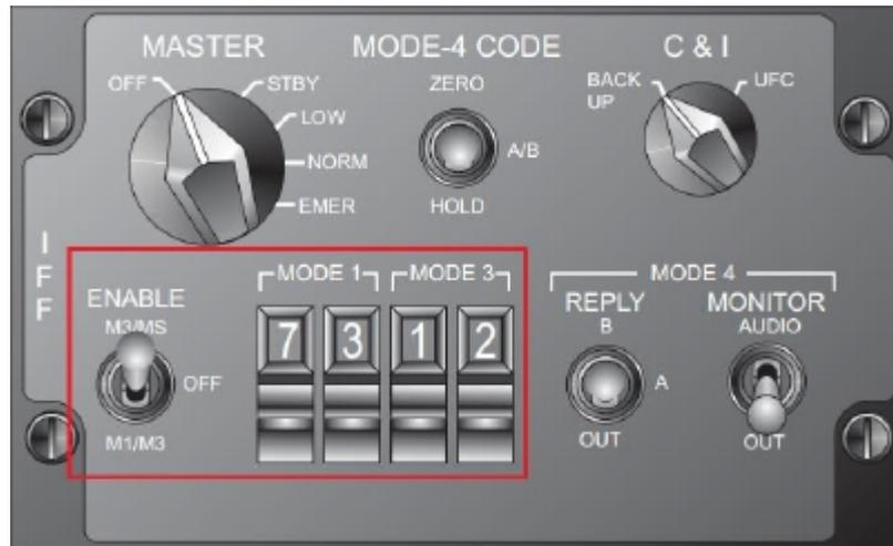
Les opérations du mode 4 se font grâce à l'interrupteur REPLY, basculé sur les positions B, A ou OUT.
