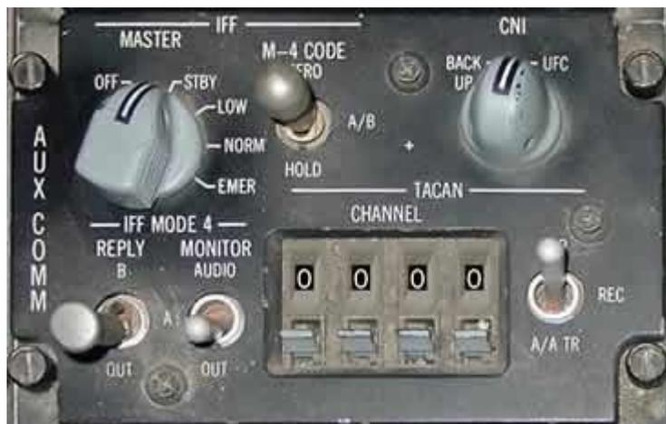
Tout d'abord, vous pouvez vérifier qu'il est allumé sur le panel IFF. Une fois le rotatif MASTER positionné sur ON et non en EMERGENCY, le commutateur CNI bien positionné sur UFC, vos interactions avec l'IFF pourront se faire sur l'ICP. Dès lors, vous pourrez accéder à la page IFF de la DED grâce au bouton s'y afférant.
